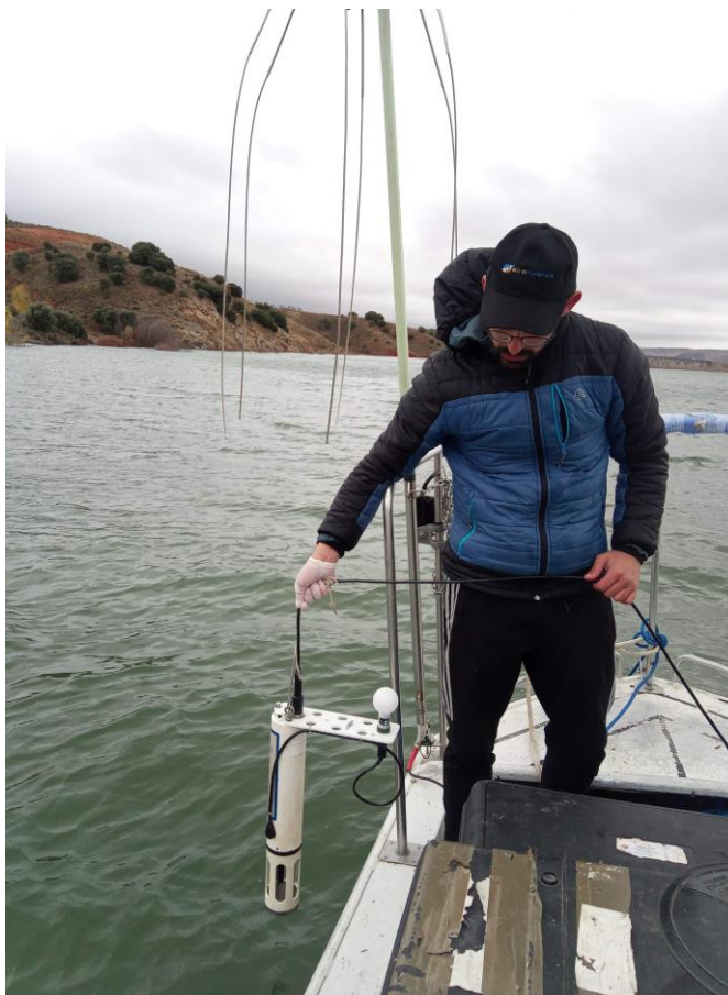
Figura 7 Técnico realizando el perfil vertical mediante sonda multiparamétrica en el embalse de Lechago
