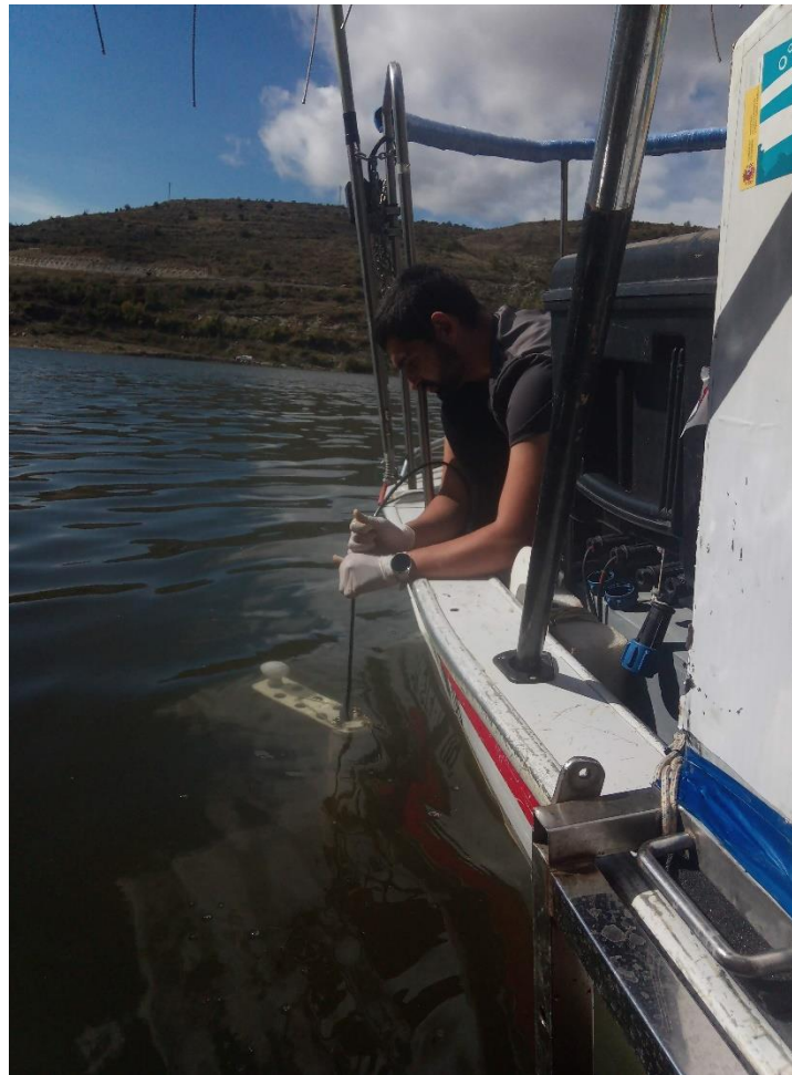
Figura 8. Operario realizando el perfil vertical mediante sonda multiparamétrica en el embalse de Soto Terroba.
