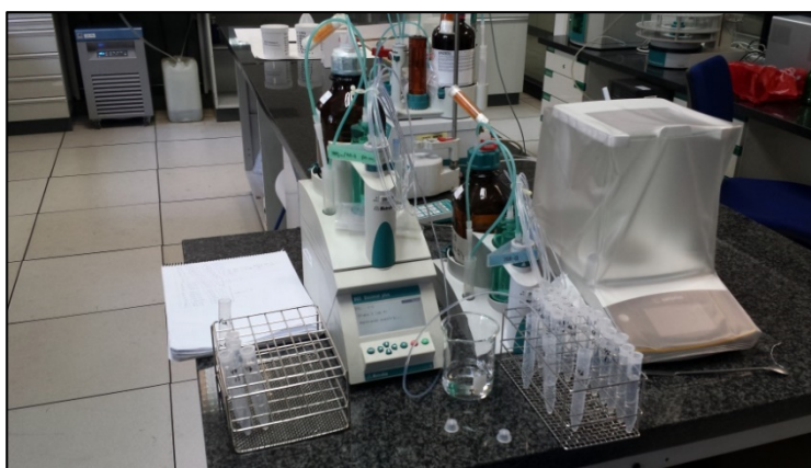
Fotografía 2. Sistema empleado para dilución de muestras
