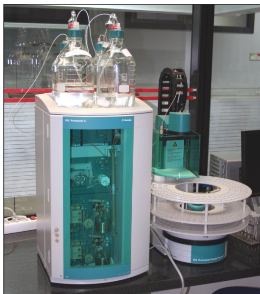
Fotografía 3. Cromatógrafo iónico simultáneo del Laboratorio de Geotecnia
