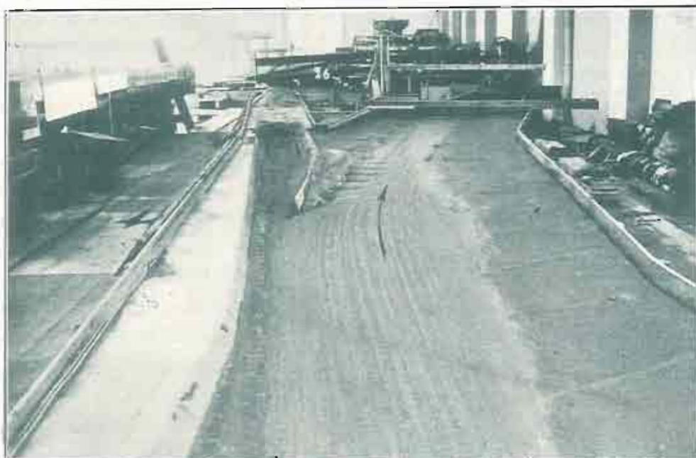
Fot. 8. Desembocadura del canal de navegación interior, llamado Miltellandkanal, en el río Elba. Obsérvese la favorable disposición de la entrada al canal, en la dirección de la corriente, impuesta por consideraciones topográficas y la curiosa prolongación del dique de la derecha del canal propuesta a consecuencia de los experimentos realizados.
