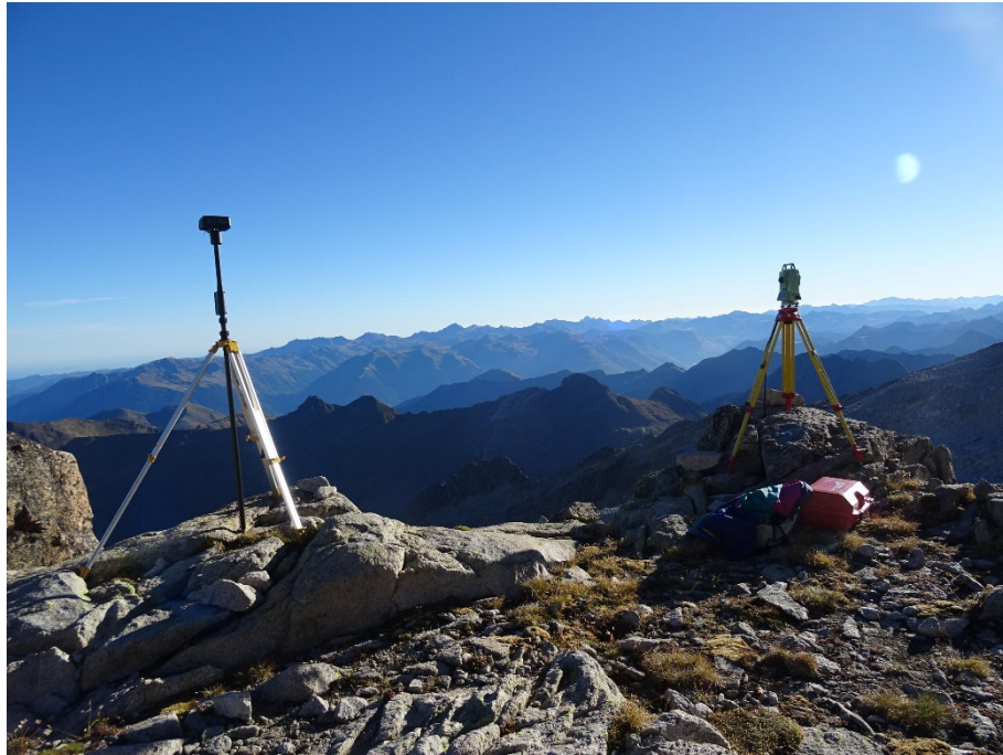
Base topográfica y GPS RTK del dron
