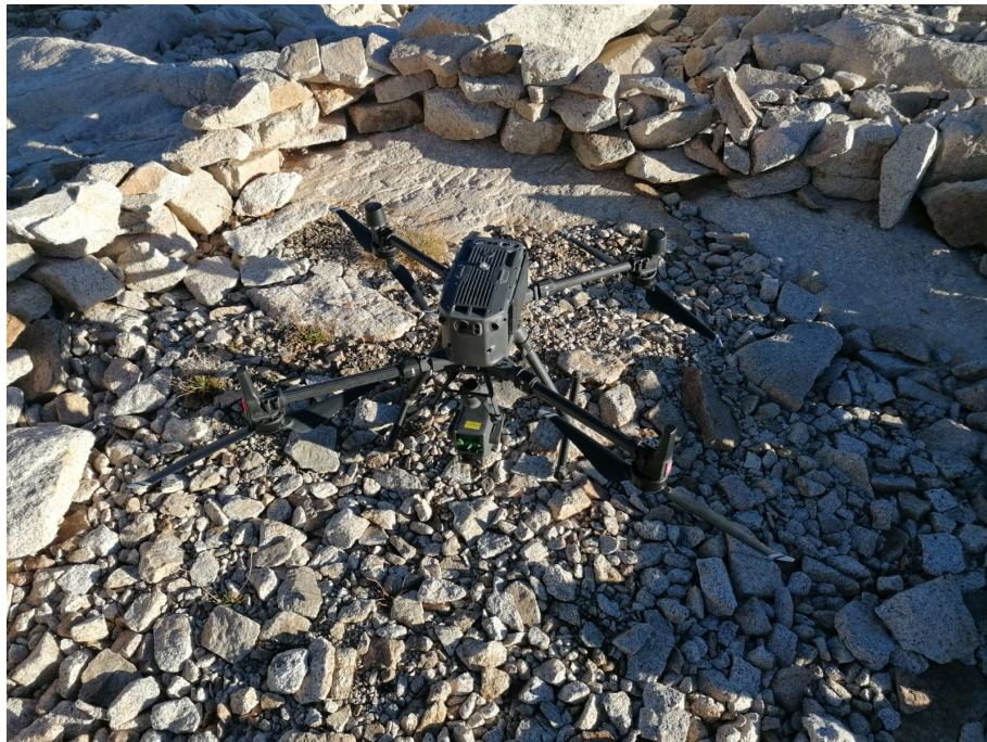
Dron Matrice 300 RTK con cámara Lidar y fotogramétrica utilizado por primera vez
