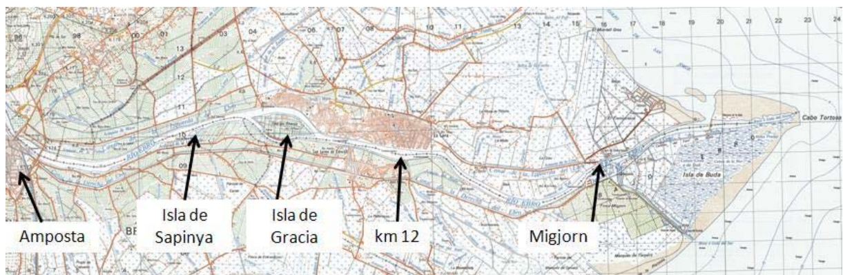
Figura 32: Situación de los puntos hasta donde llega la cuña salina en distintos caudales umbrales (ver texto).
