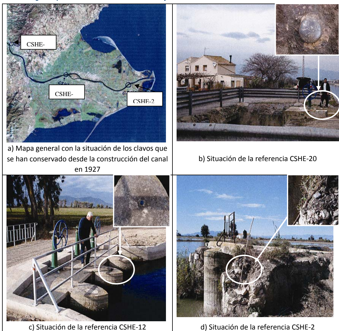
Figura 11: Situación de las referencias topográficas instaladas en 1927 durante la construcción del canal de la margen izquierda del delta del Ebro e identificación en el año 2012.
