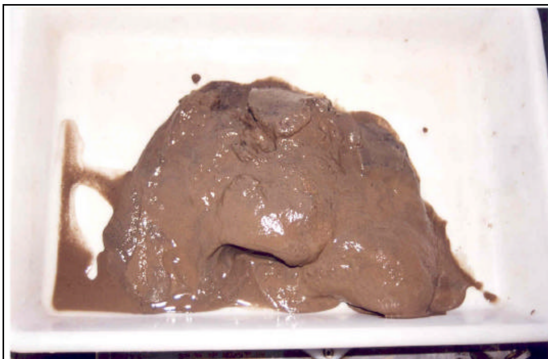
Foto 4. Sedimento extraído del embalse frente a la presa. Está oxigenado y presenta textura limoso-arenosa.
